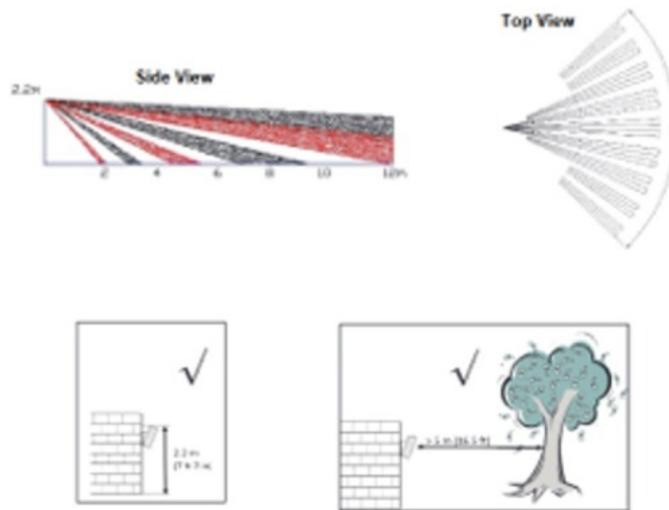
ne pas installer à moins de 5 m d'arbres ou sources de réflexion de soleil tel que bassin d'eau, surface métallique, etc. Caractéristiques générales du détecteur anti intrusion
