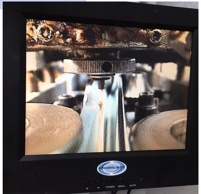
Caméra de surveillance de process dans une machine outil et affichage vidéo de l'usinage.
