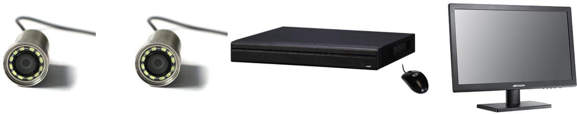
Caméra process, convertisseur XV5104-4K HDMI 1 à 4 caméras, option enregistrement vidéo, et moniteur 22" 55 cm HDMI ou VGA de controle de procesus industriel
