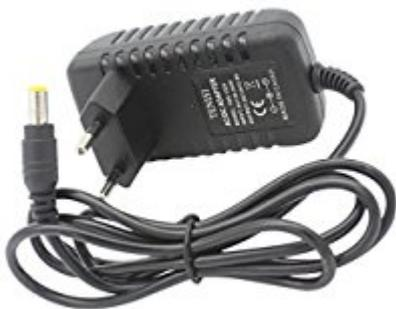
alimentation 12v pour caméra gsm Alimentation 110 - 240 v 50hz Puissance 12 W max Tension sortie DC 12v Courant sortie 1 A max Jack sortie 12v Ø 1.3 mm (+) Ø ext 3.4 mm (-) Cordon 12v 100 cm Adaptateur adaptateur jack-bornier à vis: en option Dimensions L= 75, H= 40, P= 30 mm OU L= 75, H= 50, P= 20 mm Boitier plastic , IP20 Poids 80 gr Température - 10 à + 40°C Humidité 20 à 90% Certificats CE, RoHS Signalisation -
